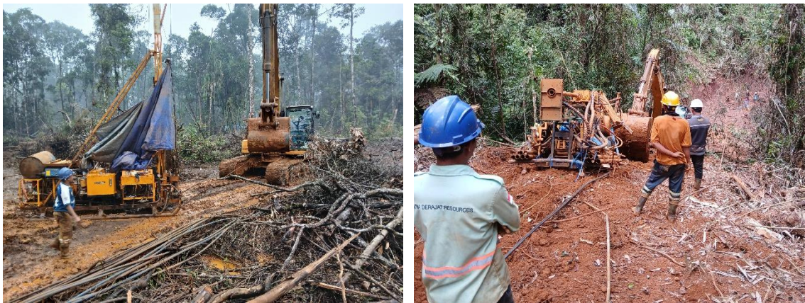
Gambar 2. Moving Alat Bor menggunakan Eksavator
