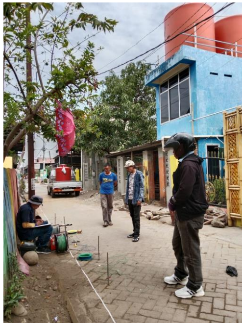
Gambar 4. Pengambilan data geolistrik resistivitas
