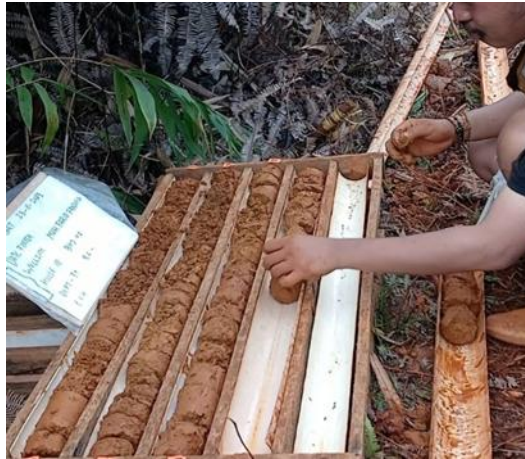
Gambar 4. Penempatan sampel dalam core box
