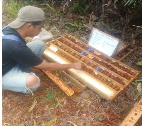
Gambar 5. Deskripsi Core Box per lapisan laterit nikel
